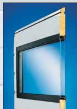
Lamela se sendvičovým prosklením typu A, tloušťka 26 mm, dvojitý rám s těsněním z EPDM.
