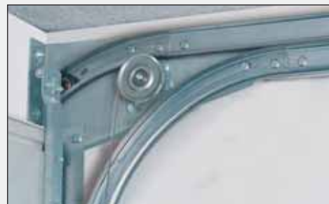
Snížené kování se vzadu uloženou pružinovou hřídelí, od výšky překladu 250 mm.
