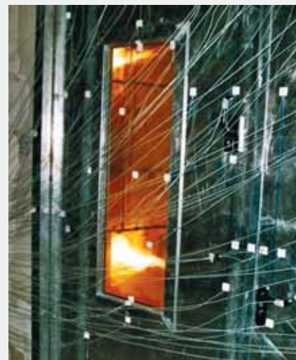
Požární zkouška s body měření teploty.
